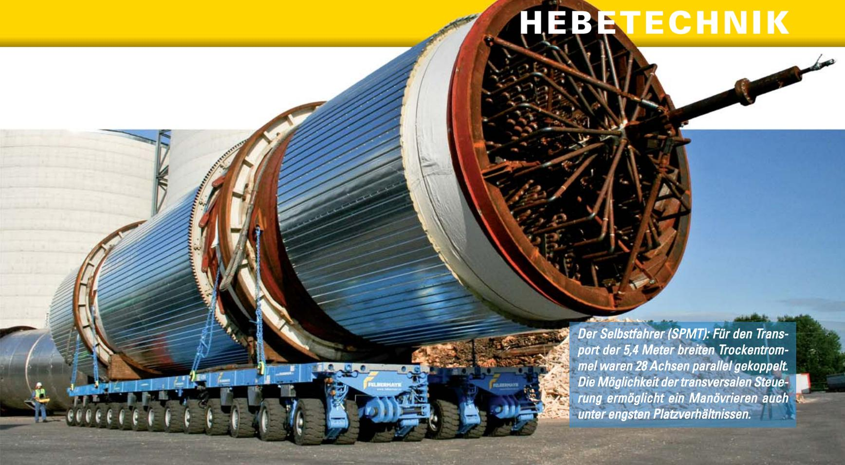
*Der Selbstfahrer (SPMT): Für den Transport der 5,4 Meter breiten Trockentrommel waren 28 Achsen parallel gekoppelt. Die Möglichkeit der transversalen Steuerung ermöglicht ein Manövrieren auch unter engsten Platzverhältnissen.*
