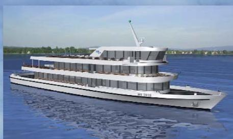
Um einen möglichst geringen Wasserwiderstand und Wellenschlag zu erreichen wurde die MS Bodensee mit Unterstützung von Computersimulationen entwickelt.
